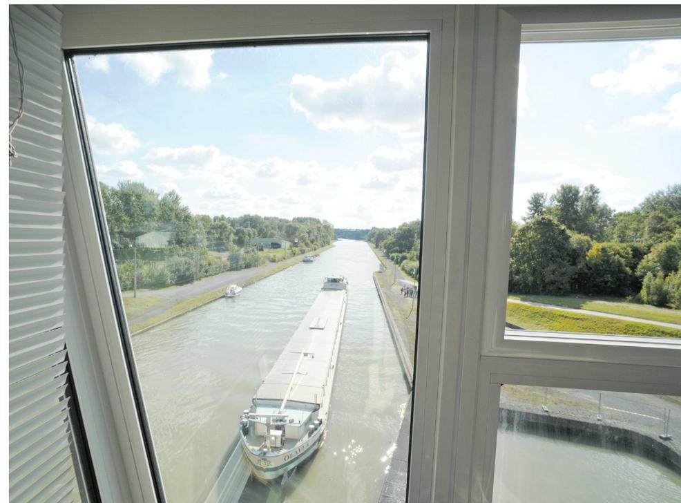
À gauche, un bateau pouvant transporter 800 tonnes de tôles, par exemple, pour l'industrie automobile francilienne. (NB: au-dessous toutefois de sa capacité maximum de 966 t utilisable quand il navigue en eaux plus profondes).
