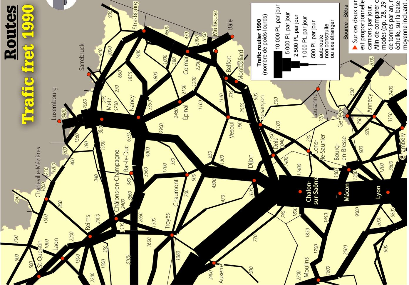
▲ Sur ces deux cartes, la largeur des tronçons est proportionnelle au trafic, en nombre de camions par jour. Afin de comparer ces trafics à ceux des autres modes (pp. 28, 29 et 33), exprimés en millions de tonnes par an, nous avons utilisé la même échelle, sur la base de 11 tonnes par camion, moyenne incluant 20% de camions vides.
